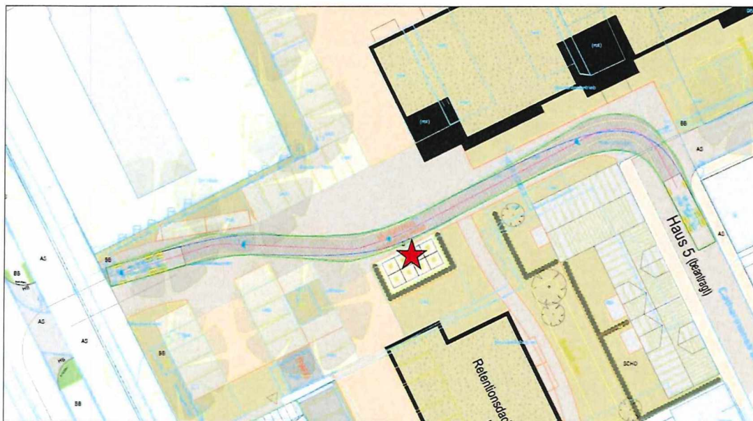
Abb. 11d „Schleppkurvenlageplan“ für Müllfahrzeug Grundstücksintern als Auszug aus der „Verkehrsuntersuchung“ zum B-Plan Nr. 196 (WVK im Juni 2021, ohne Maßstab, genordet)
