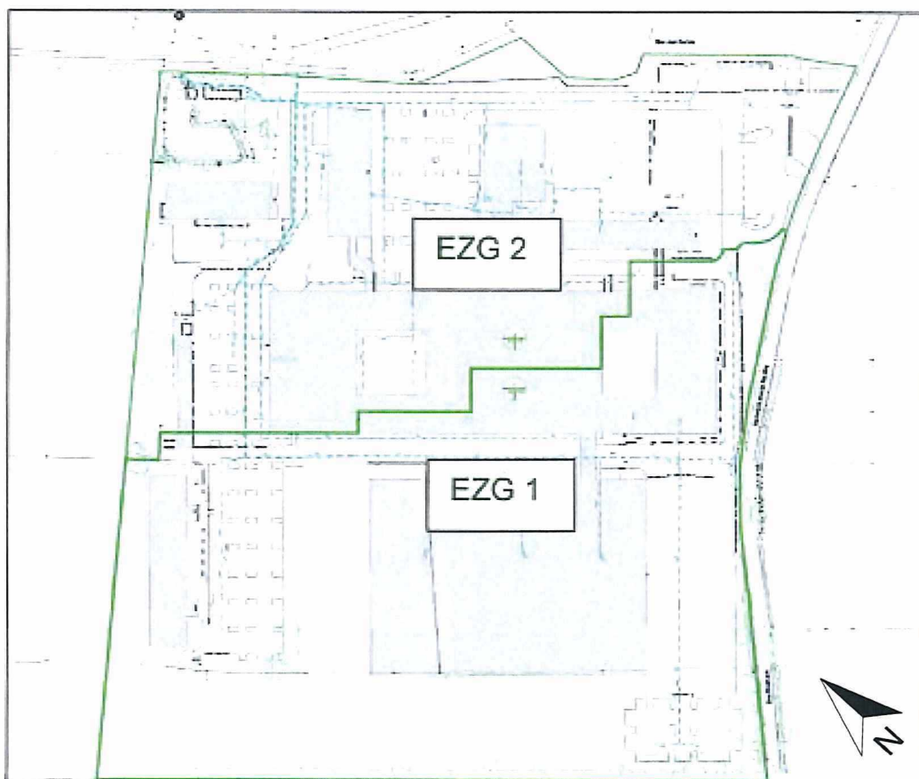
Abbildung 13 - Aufteilung Einzugsgebiete zur Entwässerung, maßstabslos, d+p, 2020
